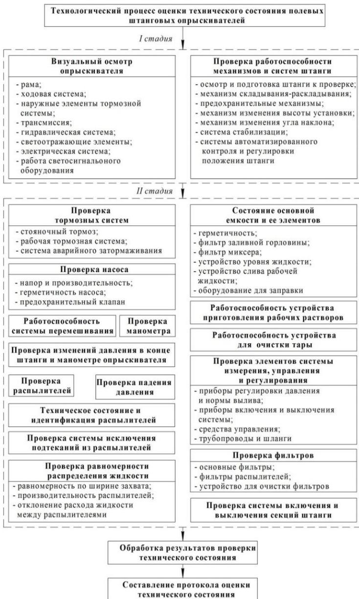
Рисунок 3. – Структурная схема процесса оценки технического состояния штанговых опрыскивателей
