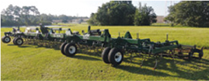
Рисунок 2. Полевой культиватор КМС 2100 компании « Kelley Mfg. Co. » (США)
