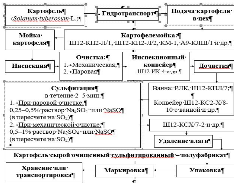
Рисунок 1. Технологическая (процессуальная) схема производства картофеля сырого очищенного сульфитированного – полуфабриката
