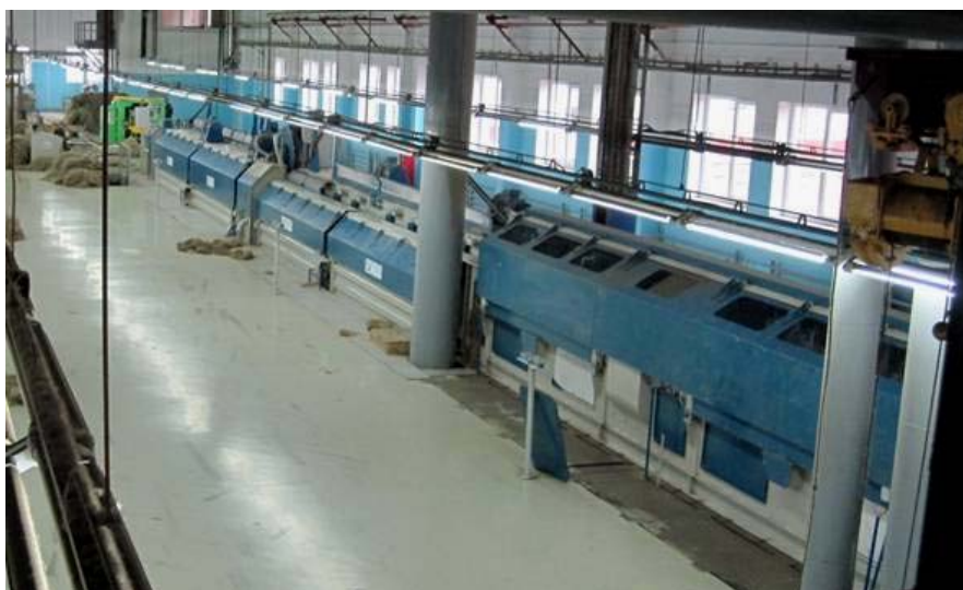
Рисунок 92 – Технологическая линия выработки длинного льноволокна «Van Dommele» на ОАО «Дворецкий льнозавод»
