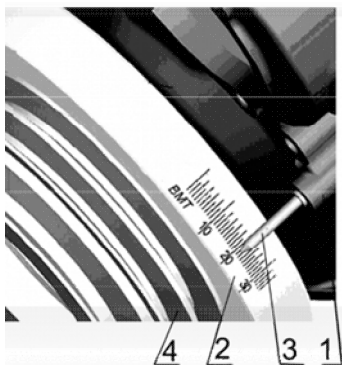
Рис. 6.7. Установка угла опережения впрыска топлива:
