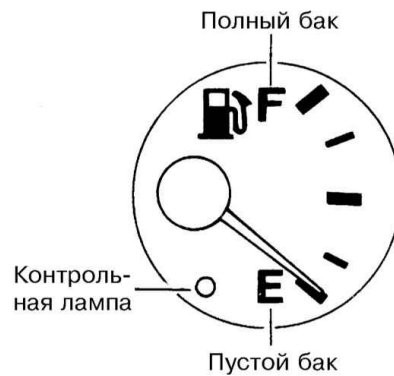
Рис. 16.6. Автономный указатель уровня топлива в баке
