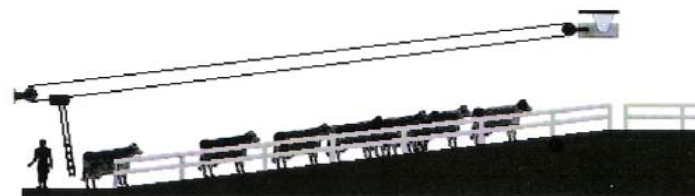
Рис. 1.25. Зал ожидания с наклонным полом
