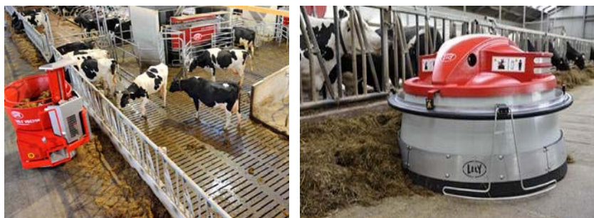
Рис. 1.13. Автоматизированная система раздачи и подкладки корма
