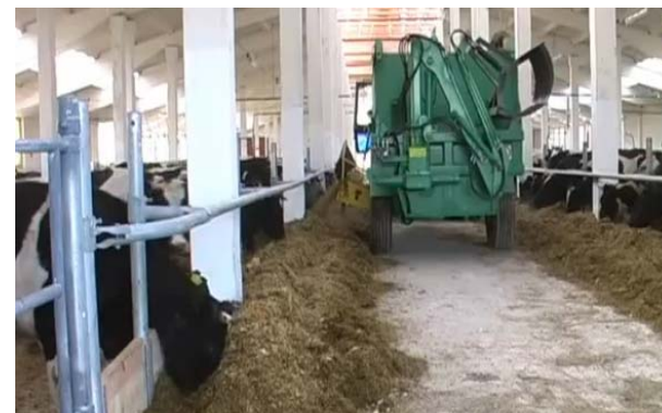
Рис. 1.12. Механизированная раздача корма
