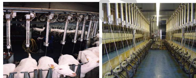
Рис. 3.5. Автоматический доильный зал: а – типа «Карусель»; б – типа «Бок о бок»
