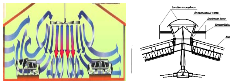
Рис. 1.10. Конструкция свето-вентиляционного фонаря «Farmtec» с регулируемым клапаном
