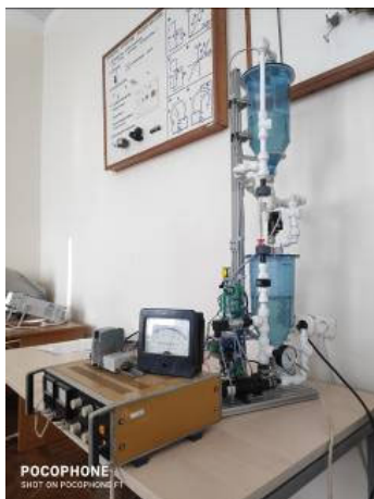
Рисунок 2 – Общий вид лабораторной модели системы водоснабжения
