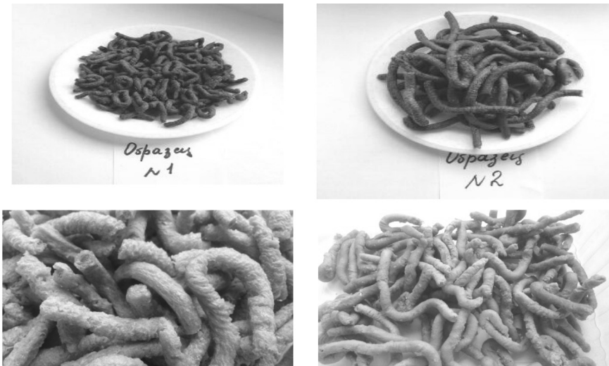
Рис. 3. Экструдаты из картофельных отходов
