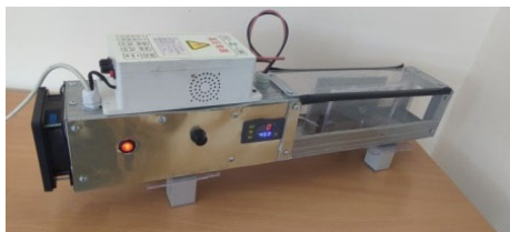
Рисунок 3 – Разработанный опытный образец электрического озонатора воздуха на коронном разряде
