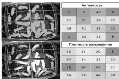
Рисунок 2. Система контроля уровня активности и плотности размещения в секции
