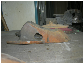
Рисунок 7 – Вид предельно изношенного анкера, не подлежащего восстановлению
