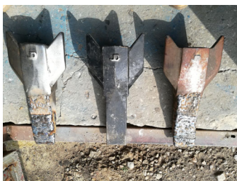
Рисунок 5 – Вид анкера после второго и третьего восстановления
