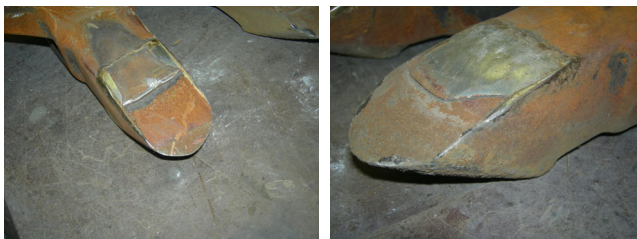
Рисунок 4 – Изменение характера износа анкера
