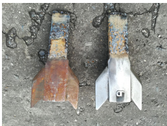
Рисунок 6 – Вид изношенных анкеров после второго и третьего восстановления
