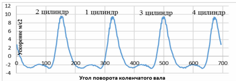
Рисунок 4 – График зависимости боковых ускорений блока цилиндров двигателя D4CB при работе на холостом ходу по углу поворота коленчатого вала.
