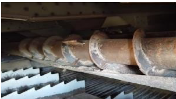
Рисунок 1 – Шнек распределительный модернизированный
