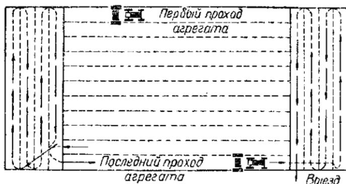
Рис. 34. Схема посева на поворотных полосах.
