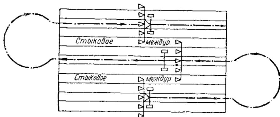
Рис. 30. Схема движения трактора МТЗ-2 с культиватором КОИ-2,8П при междурядной обработке картофеля с петлевыми поворотами.
