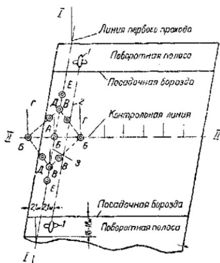
Рис. 36. Разметка поля для посева кукурузы квадратно-гнездовым способом СКГК-6.
