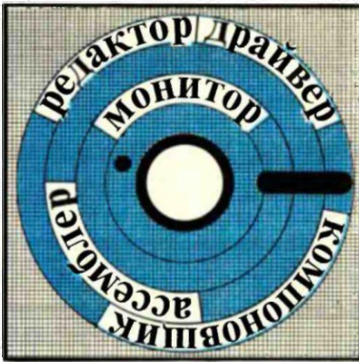
9.1 Структура ОС ДВК. МОНИТОР — дисплей, Компоновщик — редактор, Ассемблер — транслятор, Драйверы — управление периферийными устройствами. Иллюстрация взята из книги [1].
