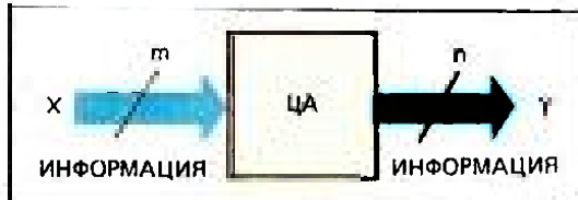
Рис. 2.1. Цифровой автомат можно рассматривать как преобразователь m -разрядных входных слов в n -разрядные выходные слова.
