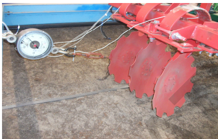
Рисунок 2 – Экспериментальная установка по определению усилия действующего на стойку
