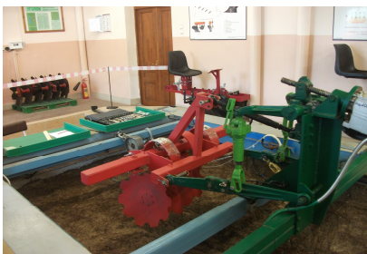
Рисунок 2 – Экспериментальная установка по определению усилия действующего на стойку
