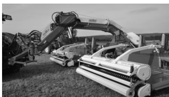
Рисунок 1. – Ленточный валкователь RESPIRO R 9 PROF1 фирмы «Reiter (RT Engineering)» (Австрия)
