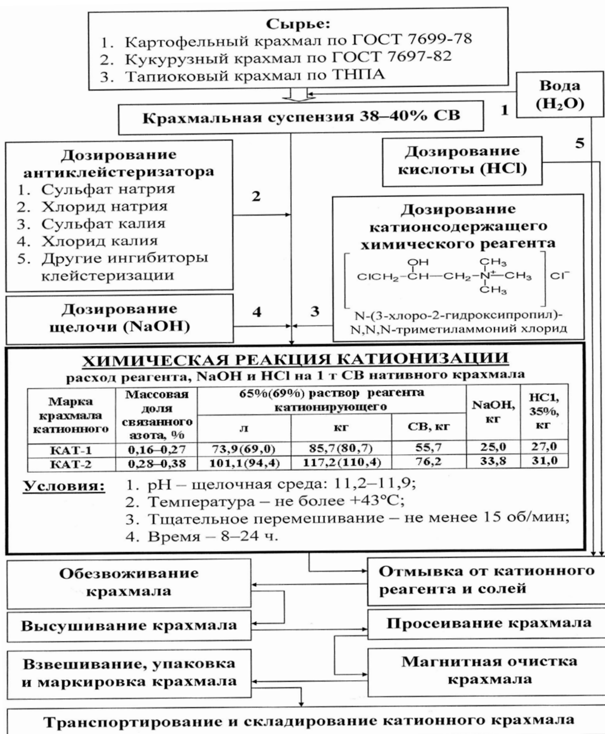
Рисунок 7 – Принципиальная технологическая схема катионизации крахмальной суспензии
