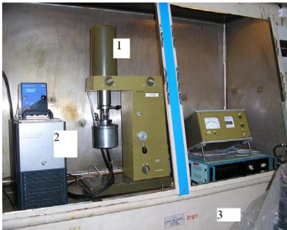
Рис. 2. Комплекс для определения реологических характеристик пищевых продуктов: 1 — вискозиметр Rheotest 2.1, 2 — термостат Huber CC1, 3 — вытяжной шкаф
