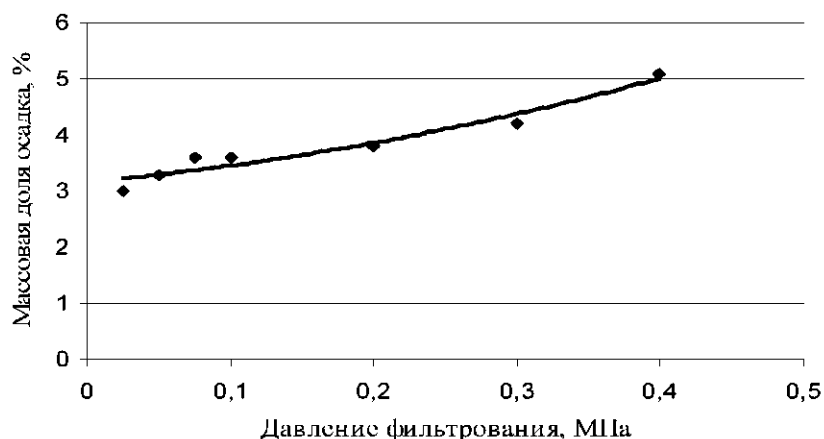
Рис. 2 – Зависимость массовой доли осадка в фильтрате осахаренной водо-картофельной смеси от давления фильтрования
