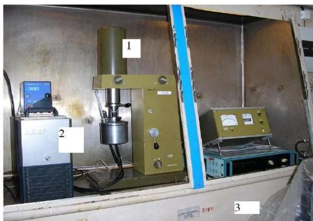
Рис. 1. Комплекс для определения реологических характеристик пищевых продуктов: 1 – вискозиметр Rheotest 2.1, 2 – термостат Huber CC1, 3 – вытяжной шкаф
