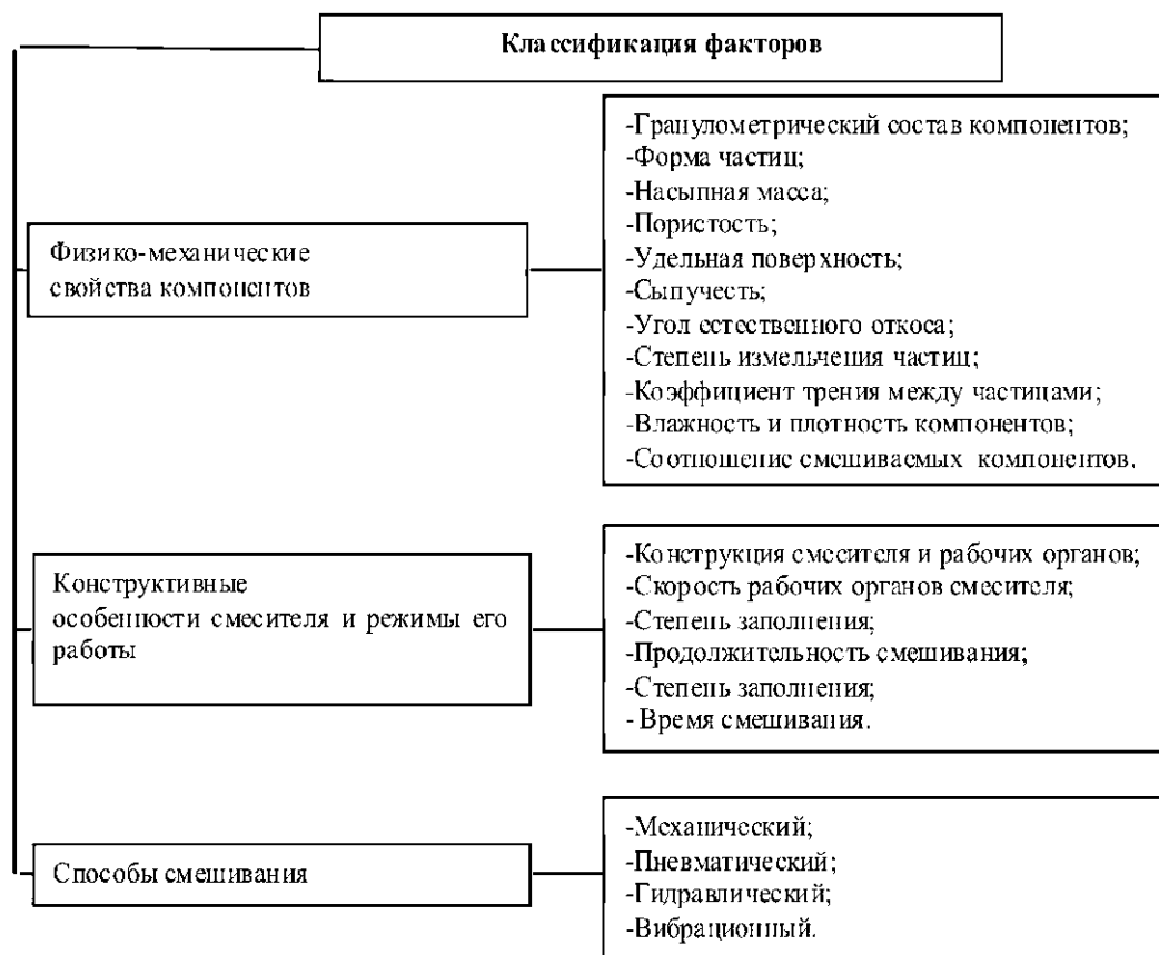
Рис. 2 — Классификация факторов, влияющих на процесс смешивания
