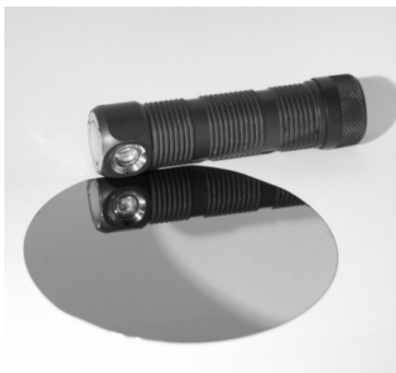
Рис. 3.31. Фотография металлооптического элемента после МАО
