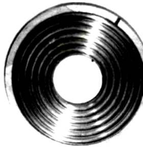
Рис. 3.19. Фотография диска-притира для обработки шаров
