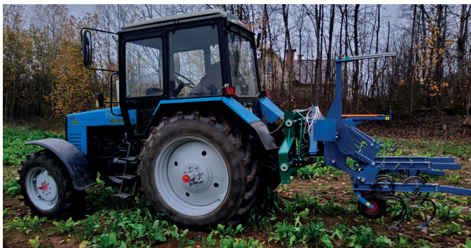
Рисунок 2 – Вид автоматической управляемой навесной системы, навешенной на трактор, при агрегатировании с пропашным культиватором
