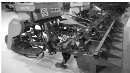
Рисунок 2 – Культиватор-окучник растениепитатель КОР-4
