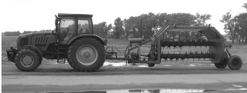
*Рис. 5.5. – Общий вид аэратора-смесителя компостов в движении*
