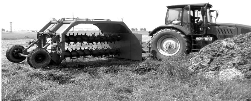
*Рис. 5.6. – Аэратор-смеситель компостов в рабочем положении*
