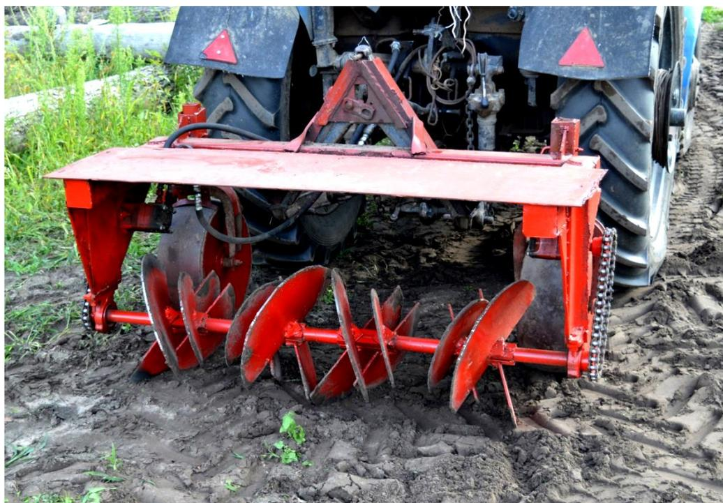
Рисунок 2 – Гребнеобразователь с активными полудисковыми рабочими органами
