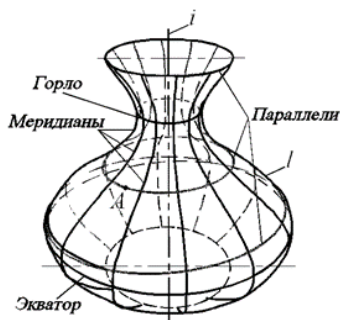
Рисунок 1 – Образование поверхности. Рисунок 2 – Поверхность вращения.
