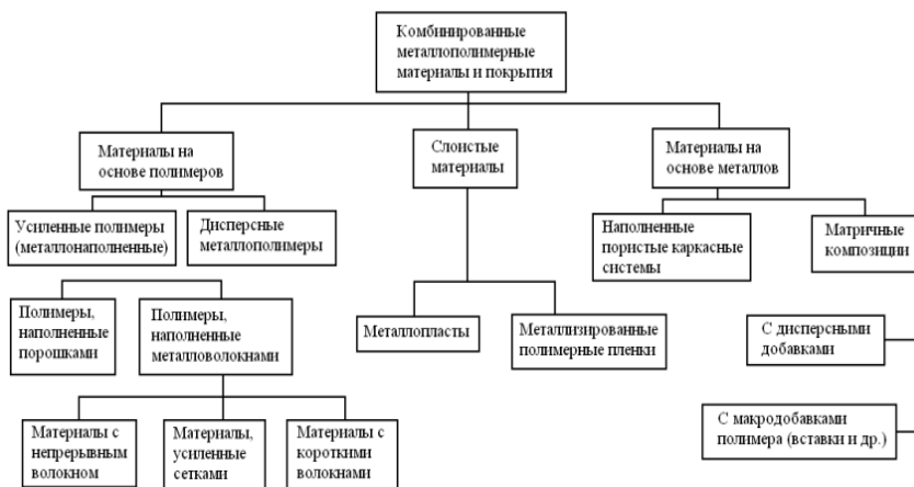
Рисунок 1 – Схема классификации комбинированных металлополимерных материалов и покрытий
