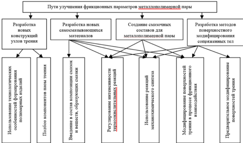
Рисунок 2 – Схема классификации технологических методов улучшения МПМ и МПП
