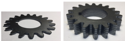
Рисунок 1 – Листовая выкройка и многослойная шестерня
