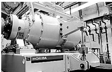
Рис. 3.44. Гидравлический тормоз фирмы Horiba
