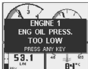
Рис. 3.11. Отображение информации о неисправности
