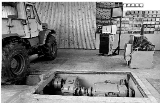
*Рис. 3.41.* Диагностический стенд для колесных тракторов КИ-8927-ГОСНИТИ (привод открыт для демонстрации устройства стенда)
