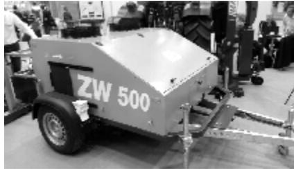
Рис. 3.46. Передвижной тормозной стенд ZW 500 с вихретоковым тормозом
