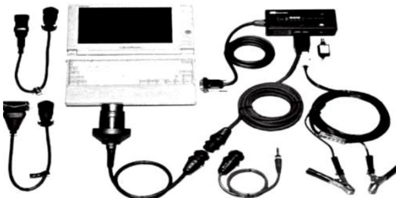
Рис. 3.21. Программируемый сканер с персональным компьютером
