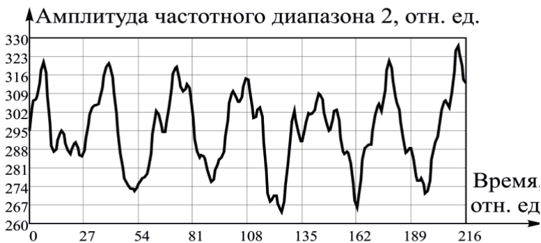
Рисунок 1. Вариант спектрограммы сигнала виброускорения для дизельной форсунки CRIN2, снятого MEMS-акселерометром на испытательном стенде CR Jet-4E
