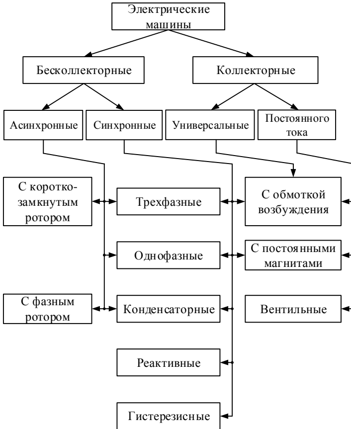
Рис. 3.1. Структура классификации электрических машин
