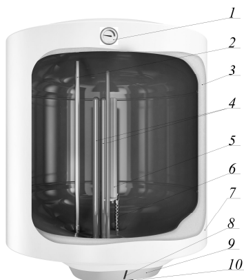
Рис. 6.3. Элементный емкостной электроводонагреватель: 1 – термометр; 2 – трубка отбора горячей воды; 3 – теплоизоляция; 4 – ТЭН; 5 – анод защитный; 6 – рассекатель холодной воды; 7 – кожух; 8 – лампочка индикаторная; 9 – крышка пластиковая; 10 – термостат
