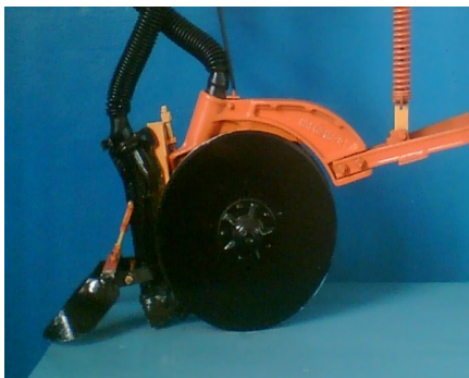
Рисунок 2. Комбинированный двухдисковый сошник
