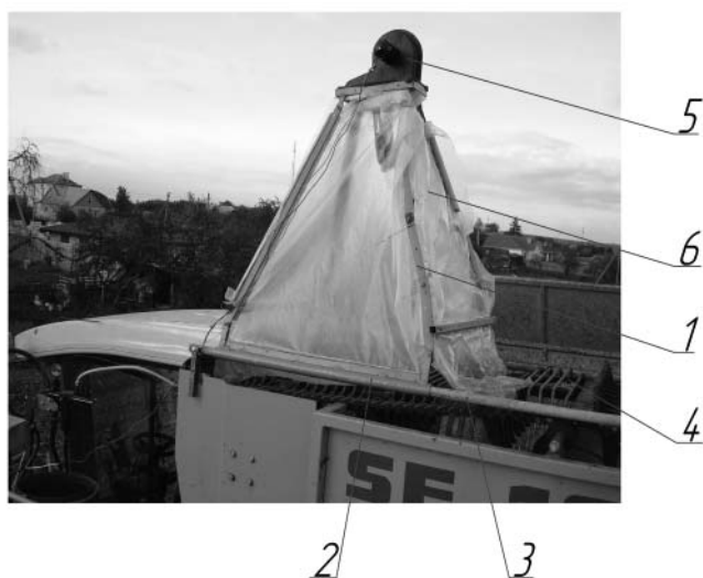
Рисунок 2. Камера протравливания в рабочем положении: 1 – боковые ребра; 2 – трубчатое основание; 3 – направляющие; 4 – циркуляционный элеватор; 5 – вентилятор; 6 – эластичный кожух
