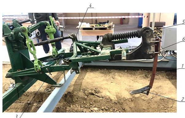
Рисунок 5. Вибрационный рыхлительный рабочий орган: 1 – вибрационная стойка; 2 – долото; 3 – навеска; 4 – проставка; 5 – навеска с предохранительным устройством; 6 – крепление вибрационной стойки
