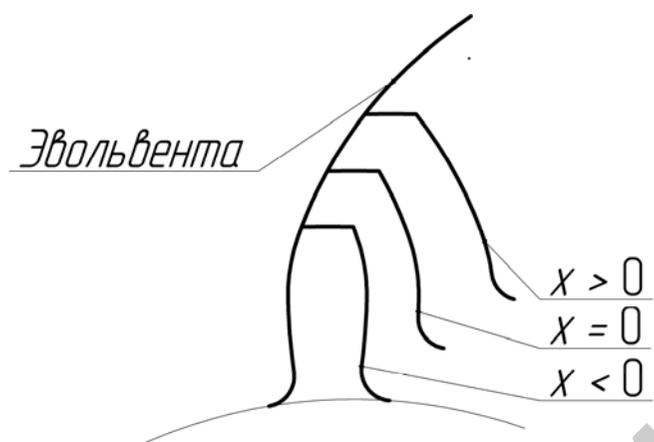
Рис. 2.16. Изменение формы зуба в зависимости от коэффициента смещения
