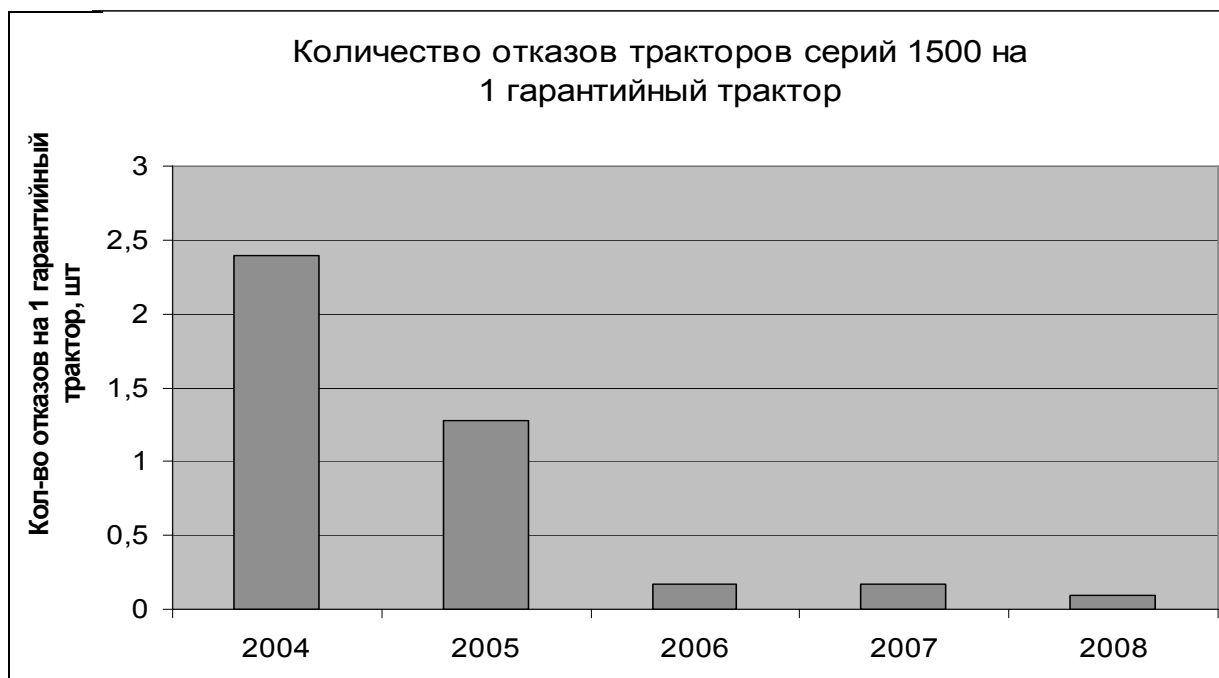
Рис. 4. Результаты подконтрольной эксплуатации тракторов «Беларус» серии 1500 за 2004-2008 гг.
