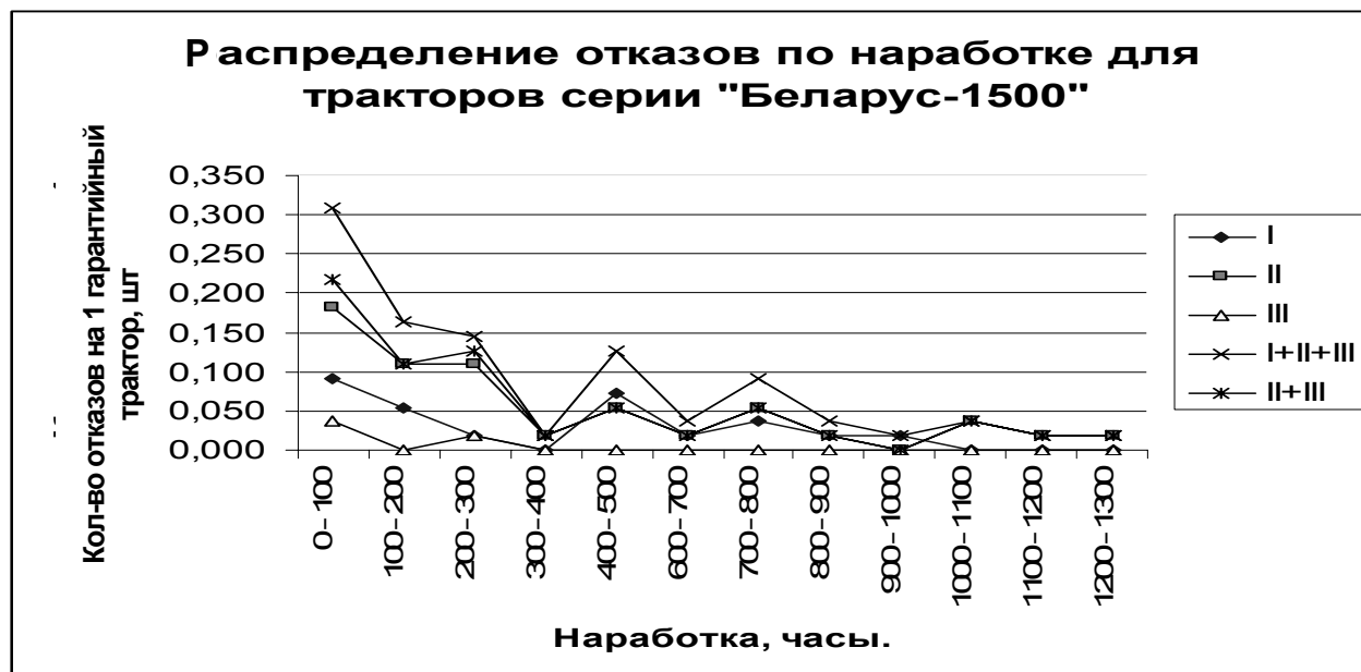
Рис. 3. Распределение отказов по наработке для тракторов серии «Беларус-1500»
