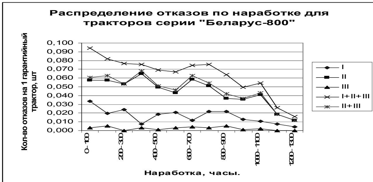
Рис. 1. Отказы по наработке для тракторов «Беларус-800» (I,II,III – отказы, соответственно 1-й, 2-й, 3-й групп сложности)
