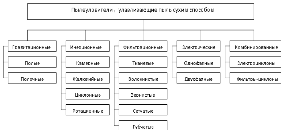
Рисунок 1. – Классификация пылеуловителей, улавливающих пыль сухим способом
