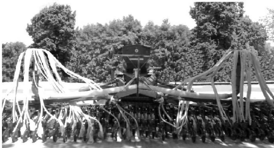
Рис. 5. Сеялка С-9, подготовленная к натурным испытаниям
