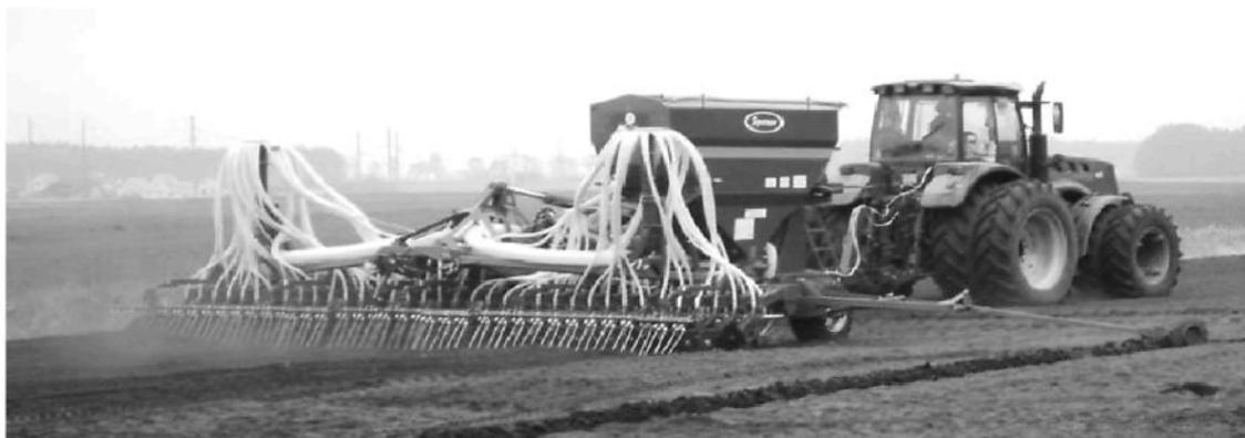
**Рис. 3.** Сеялка пневматическая зерновая С-9
