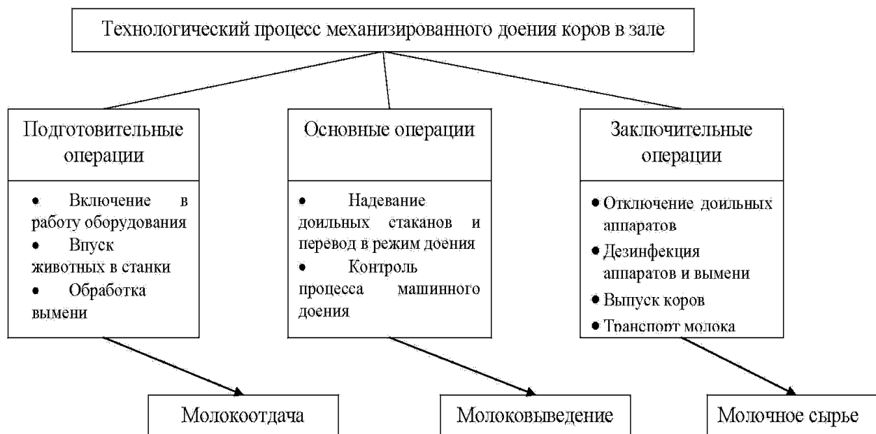
Рисунок 4. Операции процесса механизированного доения
