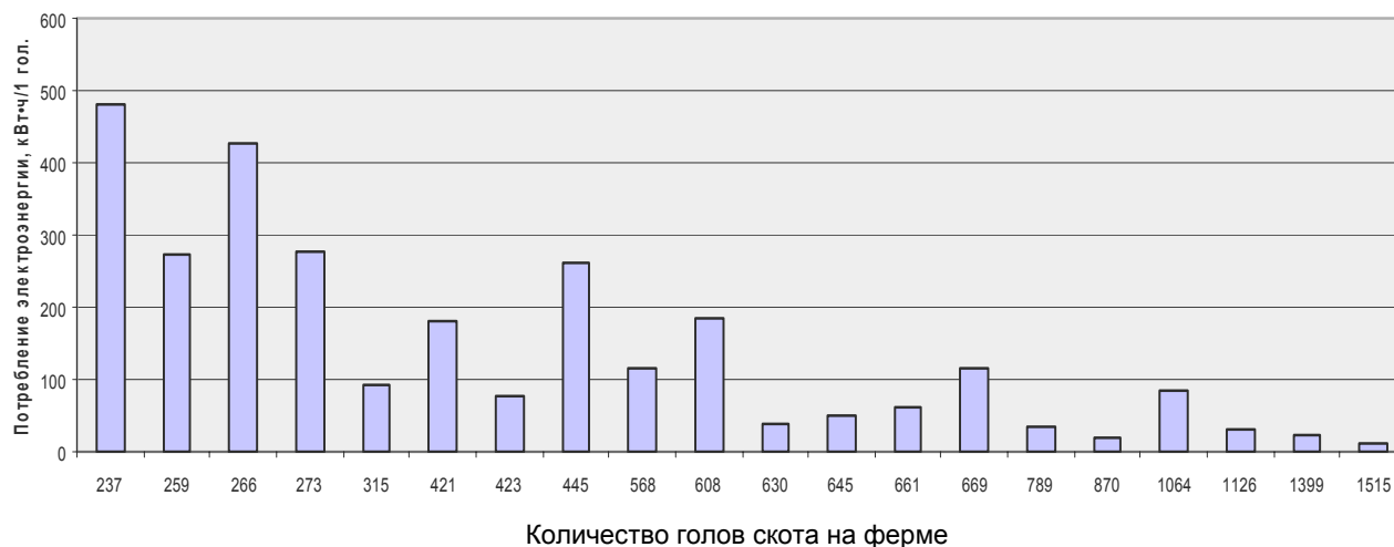
Рисунок 1. Зависимость потребления электроэнергии в год на ферме с беспривязным содержанием от поголовья скота на ней
