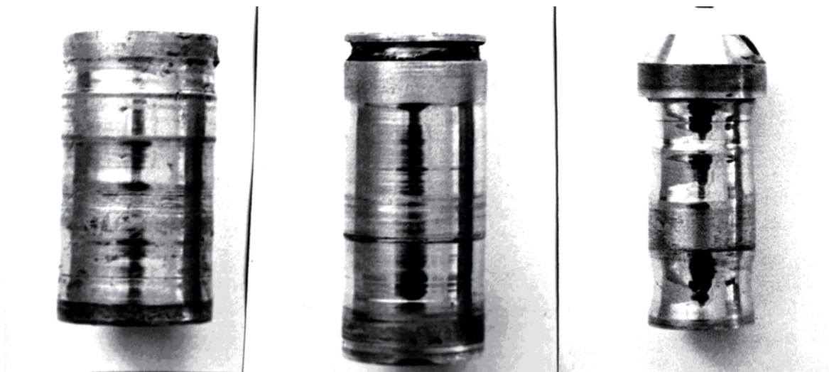
Рис. 1. Рабочие поверхности деталей, подверженных коррозионно-механическому изнашиванию при воздействии биологического фактора
