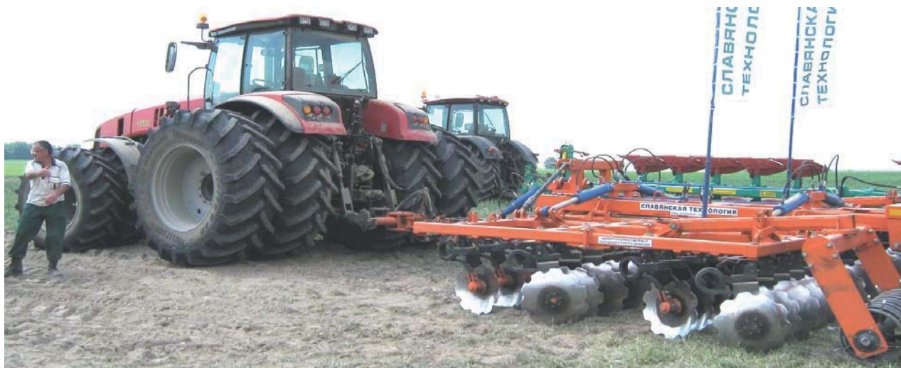
Рис.4. Трактор «БЕЛАРУС» 3522 со сдвоенными передними и задними колесами и с тяжелым почвообрабатывающим агрегатом (выставка «БЕЛАГРО – 2011»)
