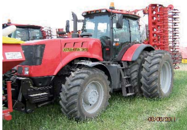
Рис.1. Сдвигание задних колес на тракторе «БЕЛАРУС» 3022
