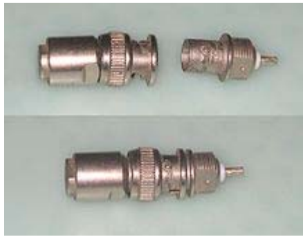
Рис. 29. BNC-коннектор ( BNC сокр. от Bayonet Neill Concelman ) для подсоединения коаксиального кабеля
