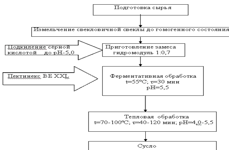
Рис. 1. Общая процессуальная схема эксперимента
