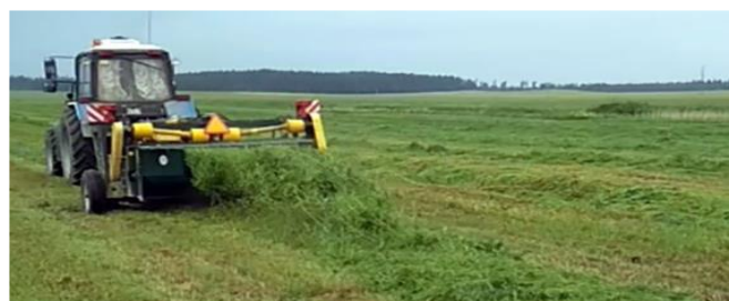
Рис. 3. Устройство УПВТ-4,0 при выполнении технологического процесса вспушивания злаковых трав
