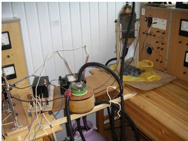
Рисунок 1 – Электромагнитный гидроциклон с продольными силовыми линиями магнитного поля (направление по движению обрабатываемой среды)
