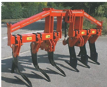
Рисунок 24 – Глубокорыхлитель фирмы «Gregoire-Besson» (Франция)
