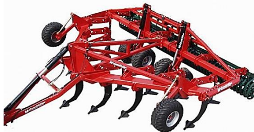
Рисунок 22 – Глубокорыхлитель Delta-New фирмы «Hatzenbichler» (Австрия)
