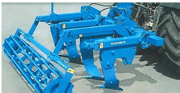
Рисунок 26 – Глубоко-рыхлитель Combi-Digger фирмы «Rabe» (Германия)
