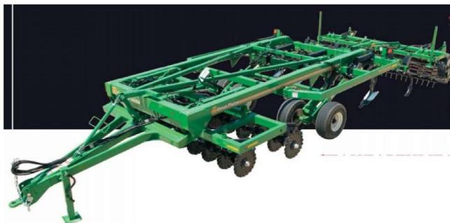
*Рисунок 27 – Агрегат для вертикальной обработки почвы «Верти-Тилл»*
