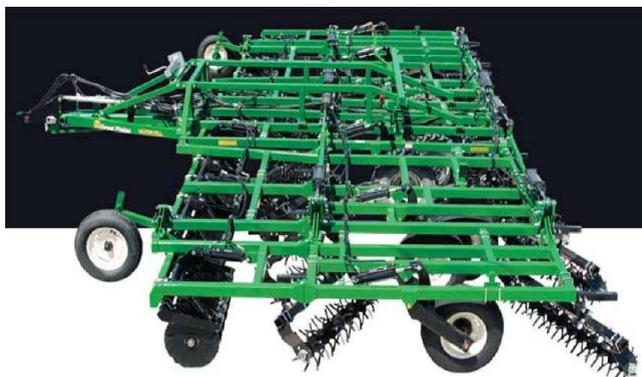
**Рисунок 24 – Агрегат для финишной обработки почвы перед посевом «Ультра-Тилл»**
