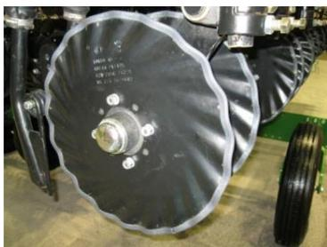
Рисунок 22 – Турбо-колтер
